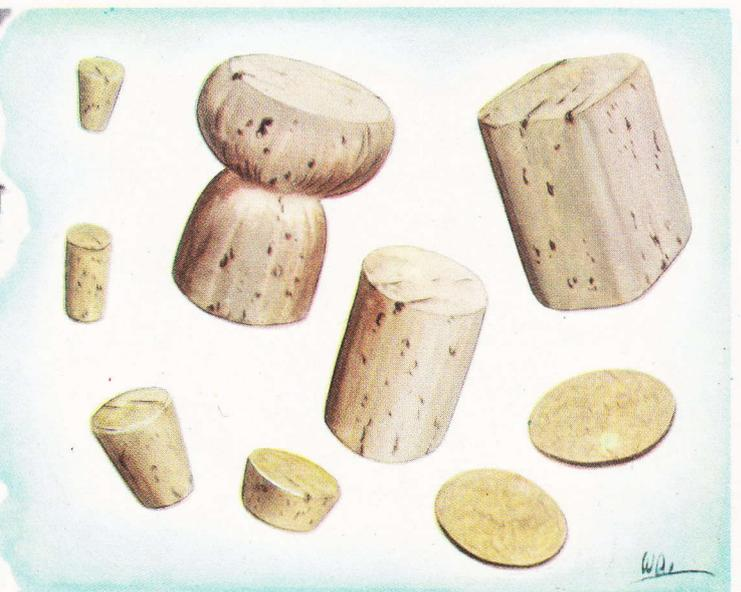
A gauche: un atelier de fabrication de bouchons. Après l'ébullition, le liège est découpé en petits cubes qui sont travaillés de manière à devenir cylindriques ou parallélépipédiques. Des opérations successives: façonnage de la tête, calibrage, stérilisation, tri, paraffinage, timbrage, parachèvement le bouchon. A droite, différentes espèces de bouchons.
