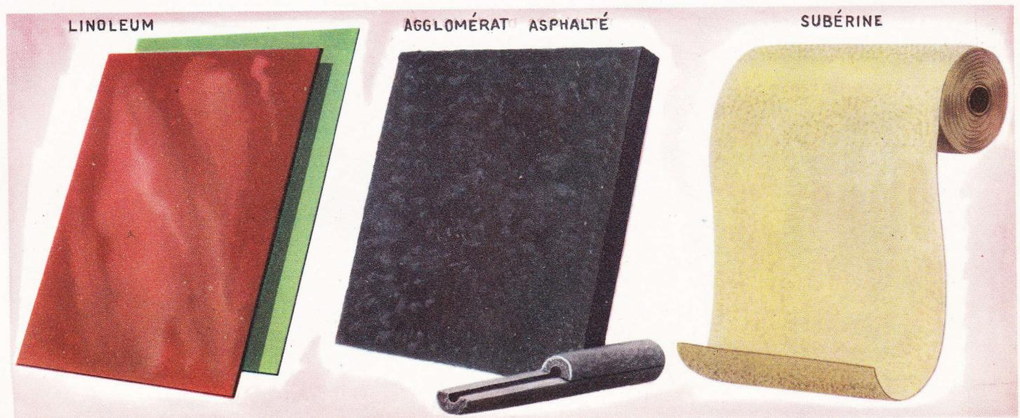
Le matériel de déchet et le liège de moins bonne qualité sont moulus et employés pour la fabrication du linoléum, qui est un composé de poudre de liège, de résines, d'huile de lin, pressé sur des tissus de lin. L'aggloméré asphalté composé de petits grains de liège, de bitume et de poix séchée, est employé comme isolant et la subérine, comme garniture de moteurs.
